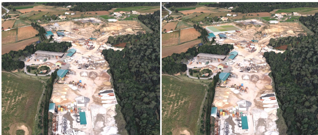
Vista aèria de la situació actual Vista aèria amb la nova nau que encapsula conté la màquina de triturar
